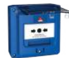
5713C1C-RF3 Déclencheur manuel bleu étanche à piles radio avec capot Émission du 2ème son/message Alarme-Menaces IP65
