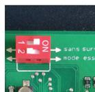
Si la détection de position des volets «**attente/ sécurité**» n'est pas nécessaire, alors basculer l'interrupteur «1» du switch **SW1** sur «**sans surv. trappes**».
