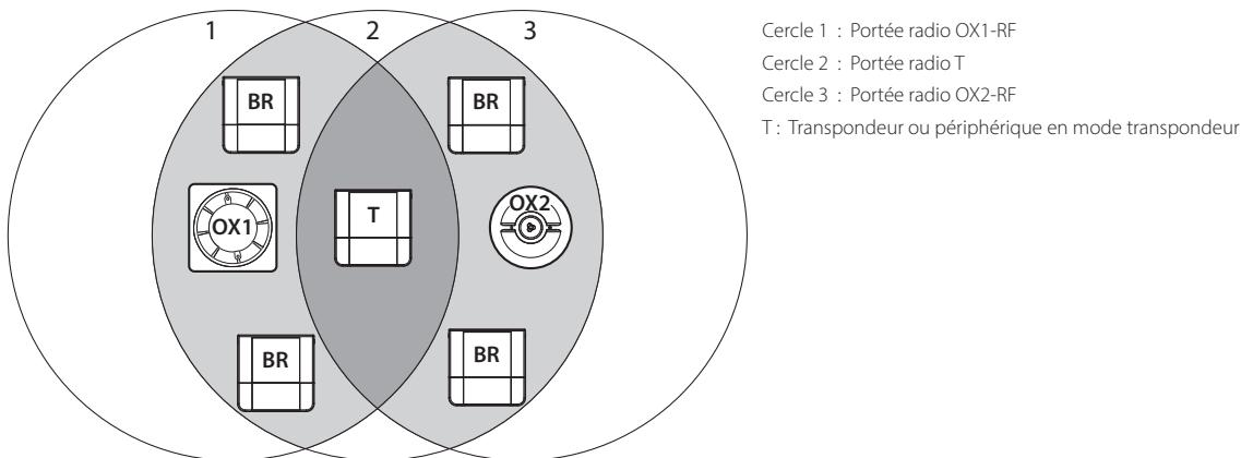
Le principe de fonctionnement de la gamme RF est basé sur des émetteurs (OX1, OX2-RF, etc.) et des récepteurs (BR-RF, etc.). Tous les récepteurs à portée radio directe ou indirecte (via transpondeur(s)) des émetteurs sont déclenchés.
